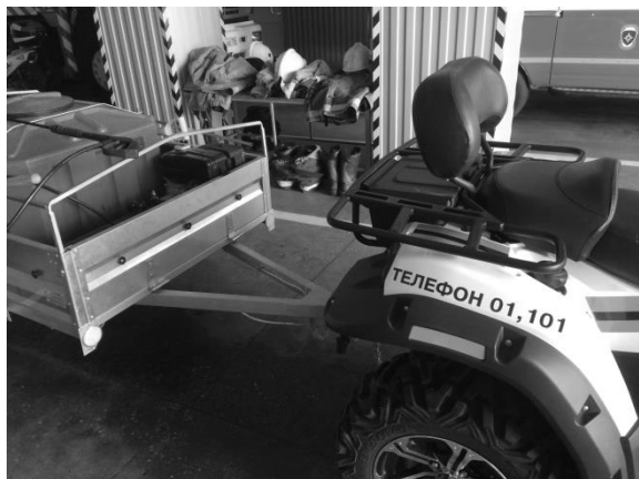
Рис. 1. Прицепной пожарный модуль, зацепленный за квадроцикл
