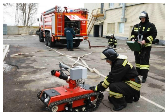
Рис 1. Действующие технологии пожаротушения с применением робототехнических комплексов
