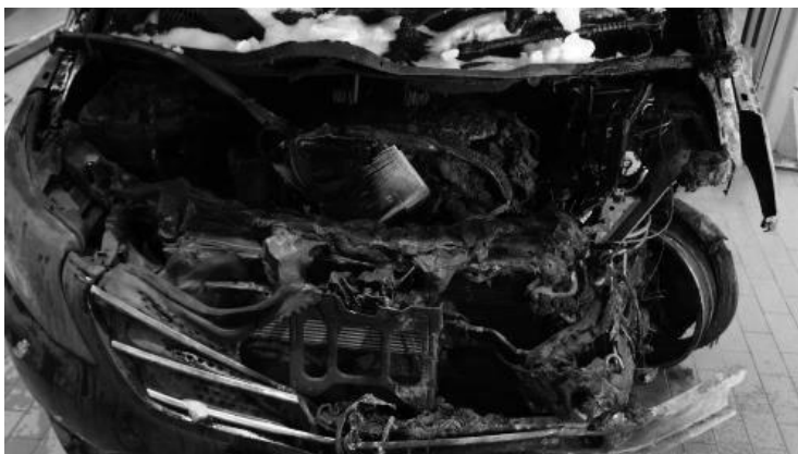
Рис. 3. Вид моторного отсека автомобиля «Mercedes-Benz VitoTourer 119 BlueTEC» после пожара
