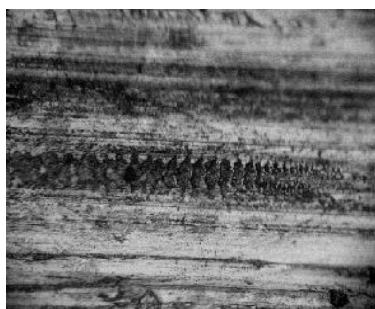
Рис. 6. Поверхность металлического вкладыша после трения в масле И-20 без наполнителей (увеличение x 500)
