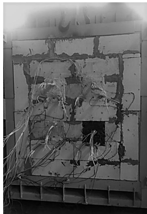
Рис. 3. Общий вид образцов кабельных проходок с необогреваемой стороны перед проведением испытаний
