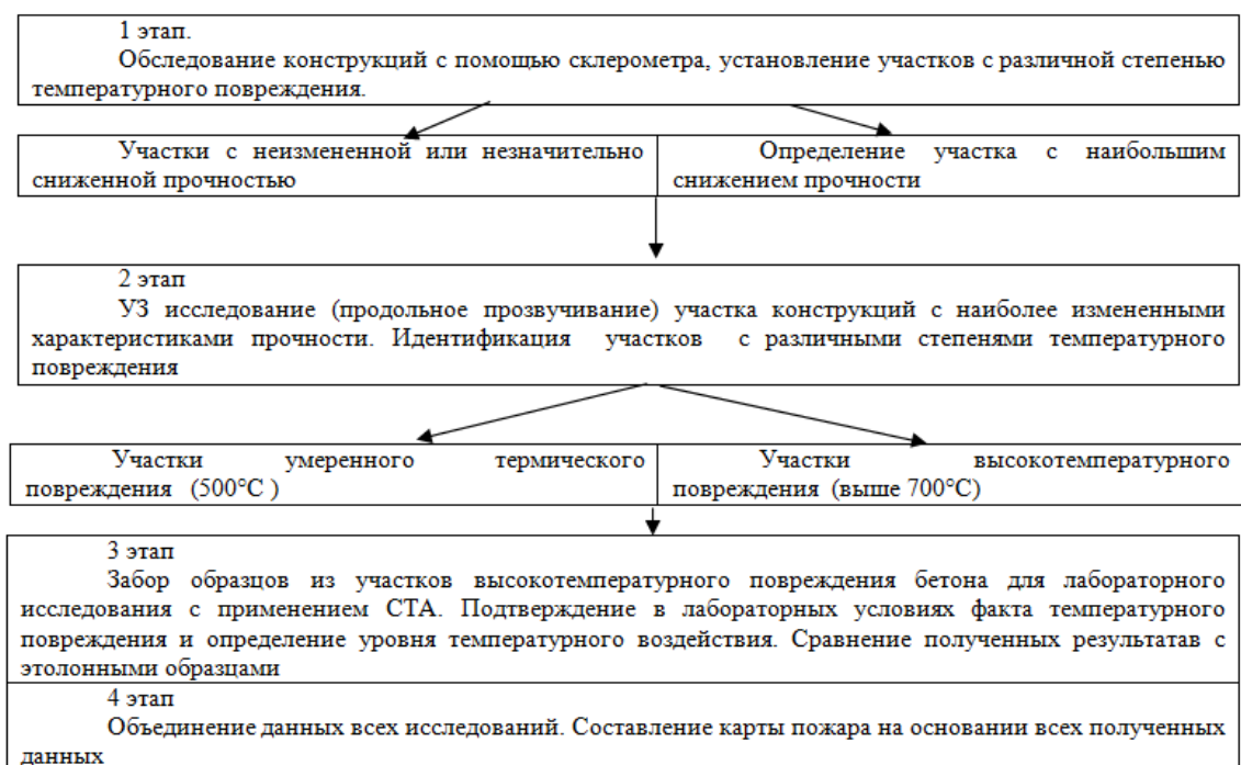
Рисунок. Алгоритм применения отдельных методов исследования прочности бетонных композитов для определения зон термического повреждения при установлении скрытого очага пожара
