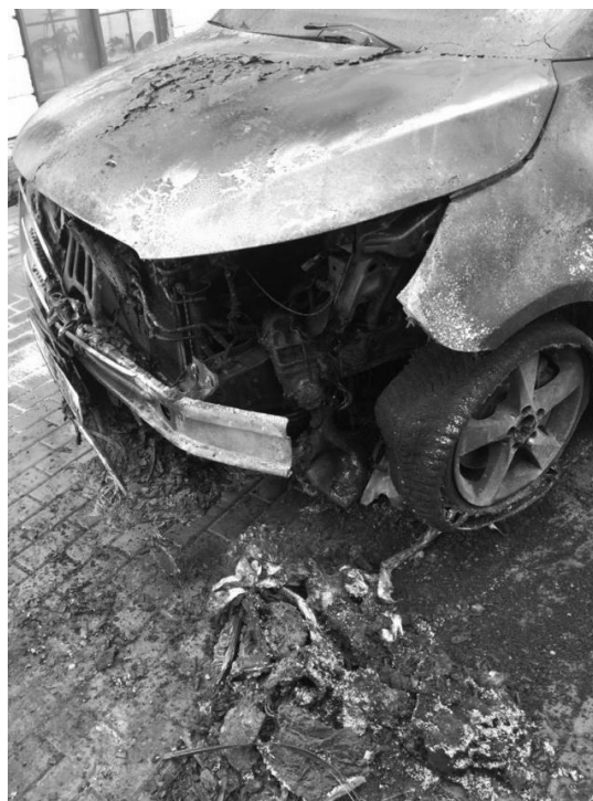
Рис. 2. Вид левой части автомобиля «Mercedes-Benz VitoTourer 119 BlueTEC» после пожара. У левого переднего колеса фрагменты пожарного мусора собранного под автомобилем
