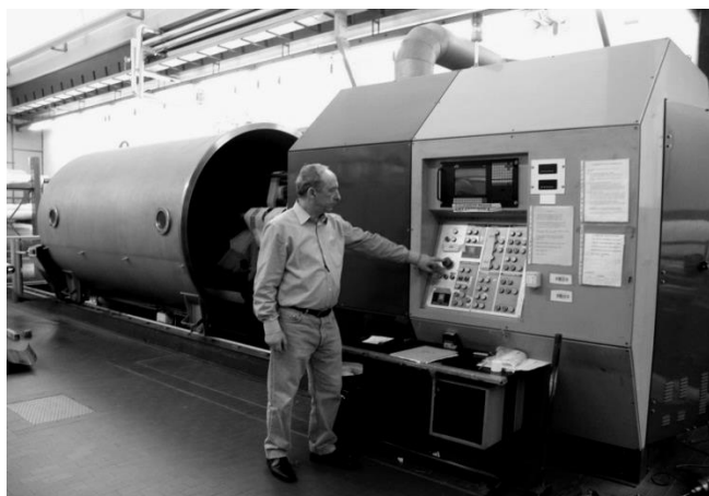
Рис. 1. Установка KPR-270 для обработки тканей в плазме пониженного давления
